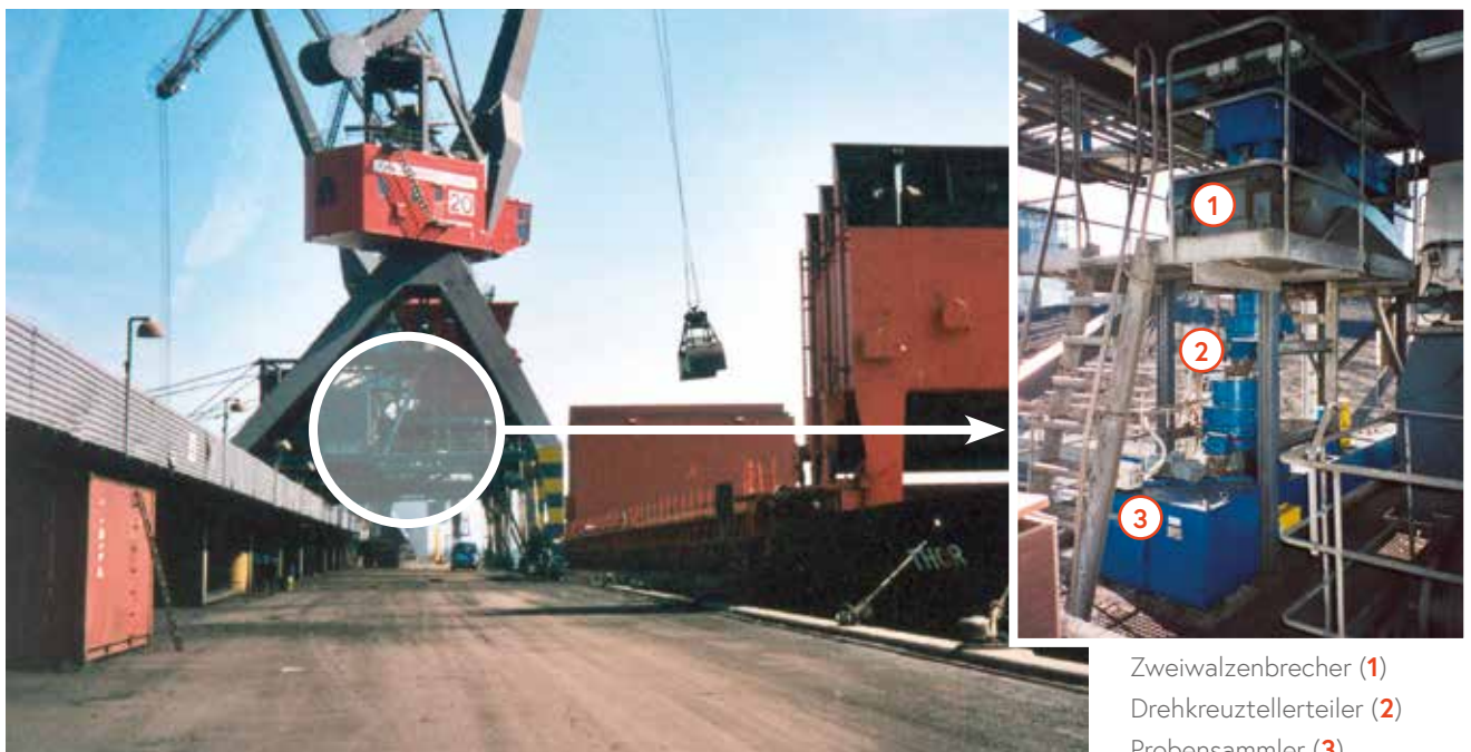
Probenahme im Entladekran für Kohle
